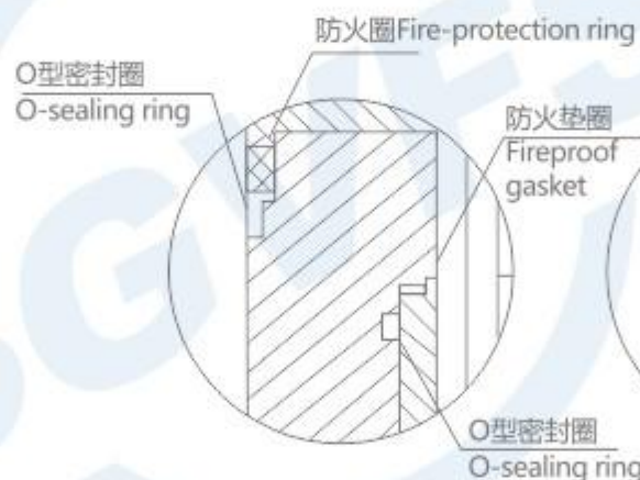
中法兰防火结构 Middle flange fireproof structure
